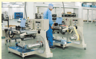
印刷後小巻に分ける 仕上げ巻取機
