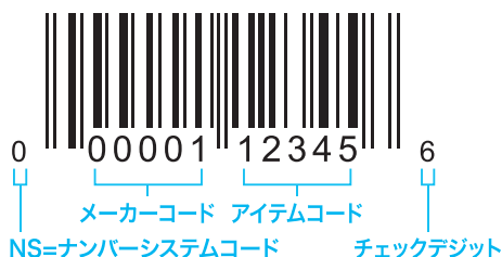
NS=ナンバーシステムコード メーカーコード アイテムコード チェックデジット
