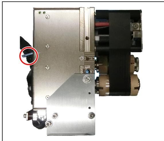
6 コントロールボックスと OM-A1 を接続しているケーブルを抜きます。
