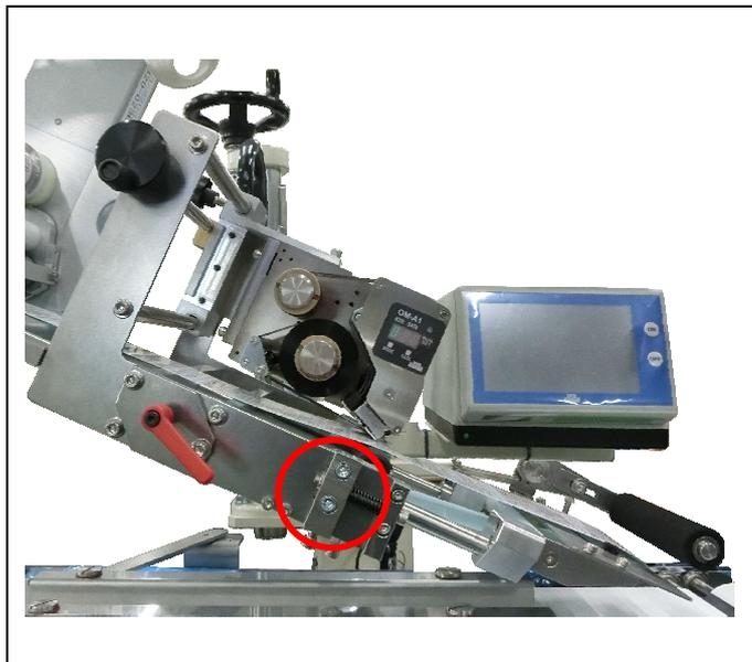
5 図示のネジを緩め、プラテンローラーの固定箇所が手順 2 において指定した 18 ~ 20 mm の範囲内に収まるよう調整します。
