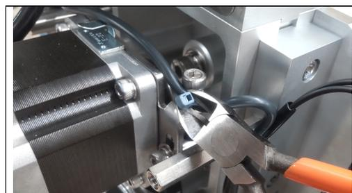
**4** モーターとカス巻プーリーを連結しているベルトを取り外します。
