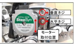
**11** モーターケーブルを接続し、ステッカー、垂直方向のネジに 結束バンドでケーブルを固定します。
