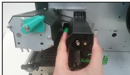
⑦ ピンチローラーを固定しているバネを2ヶ所外します。
