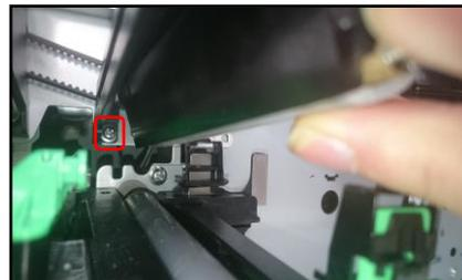
⑥ プラスドライバーで2ヶ所ネジを外し、ピンチローラーカバーを取り外します。
