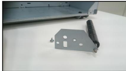
⑤ 奥側にあるネジを外す為、ピンチローラーの黒の樹脂部分を奥側の切欠きから手前に引きながら、矢印方向に引き上げ、プラスドライバーで奥側にあるネジを外します。
