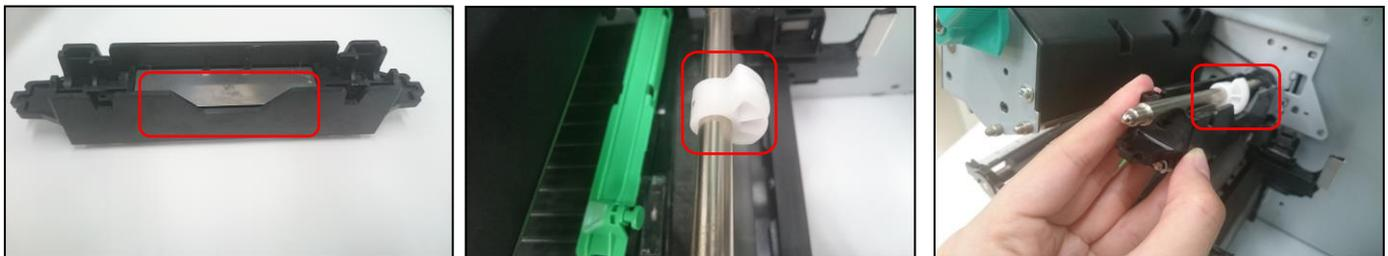
・ローラー付きプレートは、ローラー先端と差込み穴がDカットになっているので、合わせてから差込み、樹脂の切欠きとプレートの切欠きをしっかり合わせてプレートが浮かない様にネジで取付けます。
