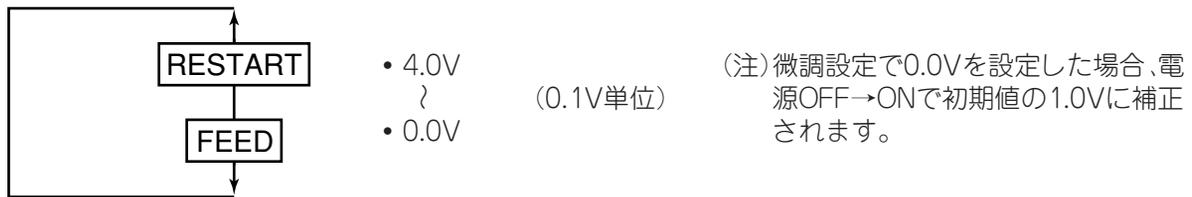
(9) 反射センサー手動スレッシュールド微調(THRESHOLD <R>)
