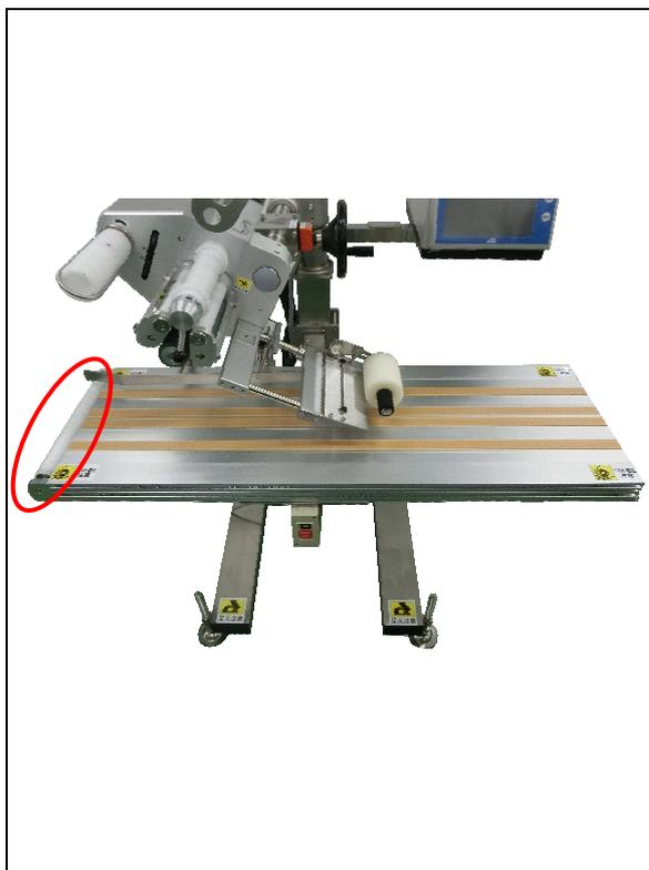
9 再度コンベヤを持ち上げて隙間を作り、コンベヤローラーにコンベヤベルトを掛けます。
