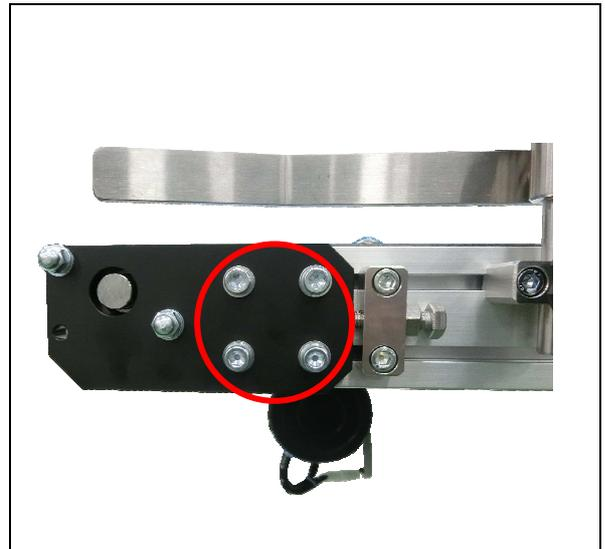
15 ベルトカバー、排出シュート等の付帯品のネジを締め、取り付けます。
