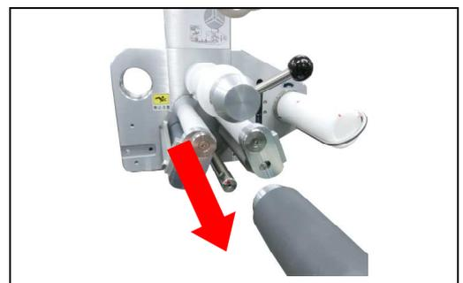
**5** セットビスはドライブシャフトの平面部分 (D カット) に対して固定する必要があります。
