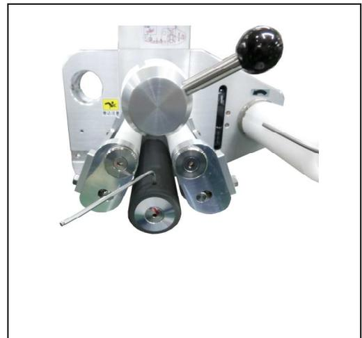
**8** 操作パネルの電源を入れ、フィードローラーが正常に動作しラベルが貼付けられることを確認します。
