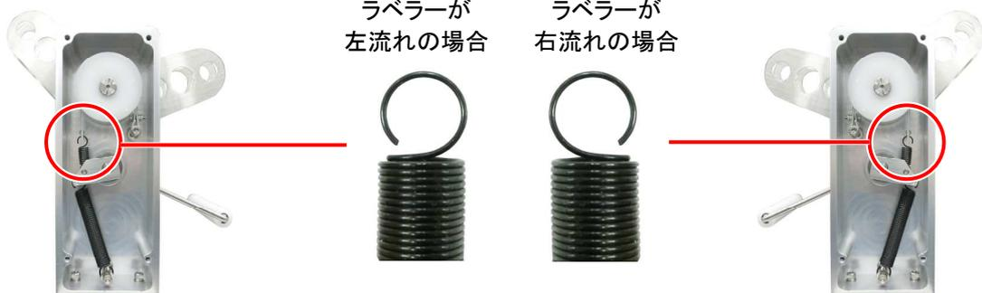
**11** 引張バネ(長)を六角穴付きボルトに掛け、ナット①および②を取り付けます。
