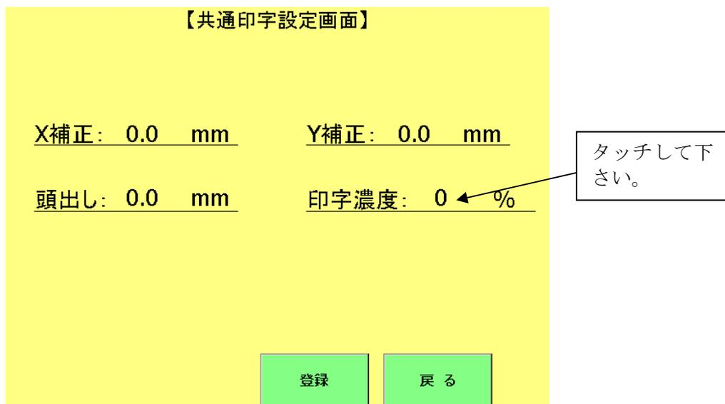
4、印字濃度の数値をタッチして下さい。テンキーが表示されますので値を入力して下さい。変更後、OK であれば登録ボタンを押してください。設定が変更されます。
