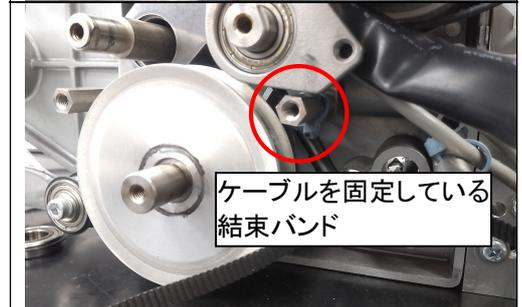
**15** タイミングベルトからファイバーケーブルを外すため、ラベルセンサーの線を一度取り外します。
