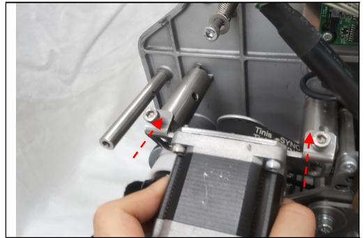
**26** タイミングベルトをモーター横の垂直ネジで張り、人差し指で矢印の位置のベルトを押したとき2 [mm]程度動く貼り強さにします。
