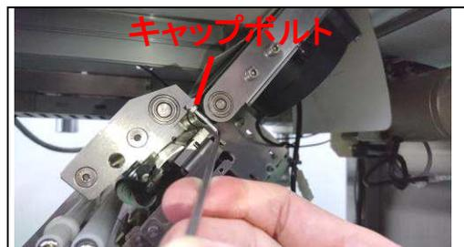
**11** サブプレートを固定している皿ビス 2 個所を取り外します。
