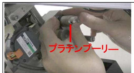
**18** プラテンプーリーの片方のセットビスが、軸のDカット面で固定できるよう位置を調整しセットビス2箇所を固定します。
