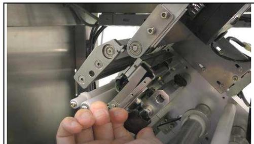
**10** 剥離プレートを固定しているキャップボルト 1 個所を取り外します。
