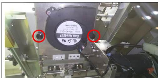
**8** 操作パネルの電源を入れ、MX ファンが正しく動作していることを確認します。
