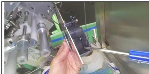
**7** ファンプレートを取り付け、つまみネジを締め付けます。
